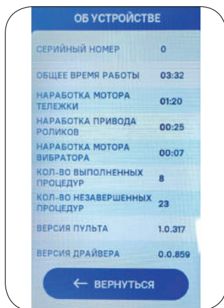
Рисунок 10 – Экран сервисной информации об устройстве
