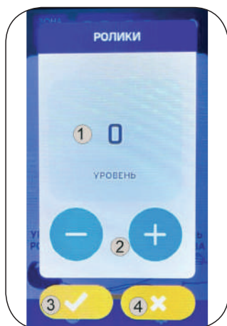
Рисунок 6 – Экран настройки уровня высоты подъема роликов
