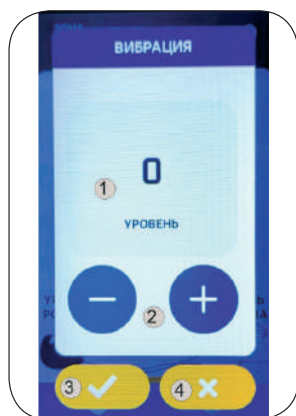
Рисунок 7 – Экран настройки уровня вибрации роликов
